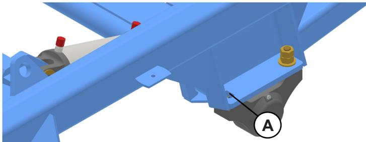
O equipamento possui ajuste nos mancais dos rodeiros através dos rasgos (A). Este ajuste serve para centralizar os rodeiros com a estrutura da grade e para eliminar folgas laterais entre o eixo de articulação e os mancais.
