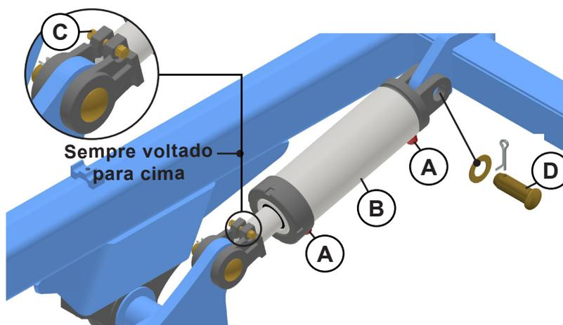
Em seguida faça a movimentação de 180°, deixando os terminais (A) virados para cima e permanecendo a haste do cilindro voltada para a direção do rodado (E) da grade, como ilustra a figura.
