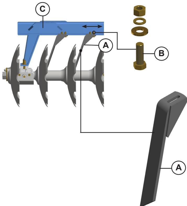
Observe a posição de fixação dos limpadores e a montagem com a extremidade voltada para o lado da concavidade dos discos.
